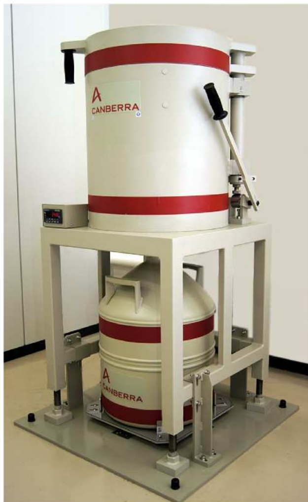
ゲルマニウム (Ge) 半導体検出器付き ガンマ線スペクトロメータ
