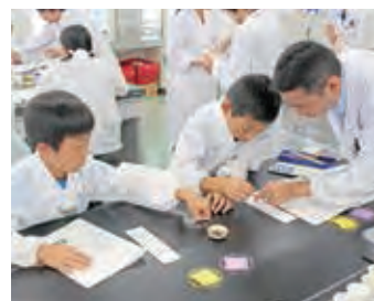
取り出した着色料を毛细管でスポットします。
