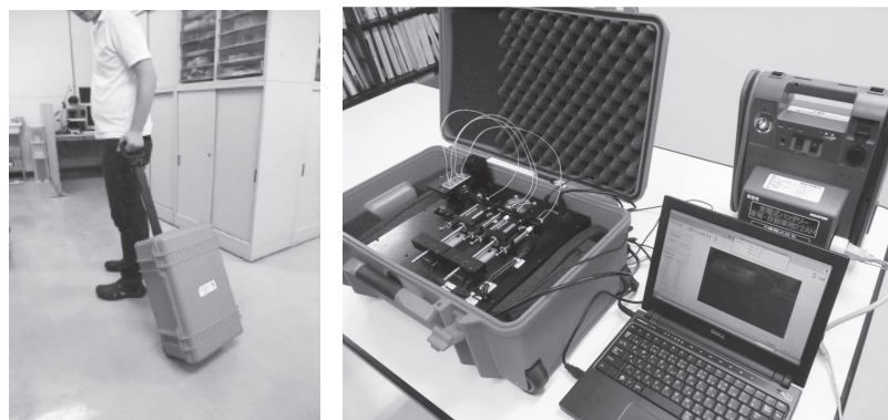
写真4 on-site 微生物モニタリング用に作製したポータブル・マイクロ流路システム
